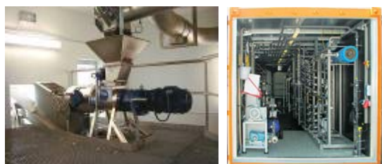
Abbildung 3.4.1 Pressschnecke (links), Membran-Containeranlage mit Ultrafiltration und Umkehrosiose (rechts); Fotos: FAN Separator (links), Haase Energietechnik (rechts)
