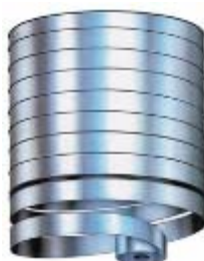
Abbildung 3.2.2 Beispiele für Fermenter in Stahlbauweise (hier: volldurchmischte, nicht einsehbar); geschraubte Platten (links), Prinzipskizze für gewickelte Blechbahnen, Prinzip (rechts); Fotos: GLS Tanks International GmbH (links), Lipp GmbH (rechts)
