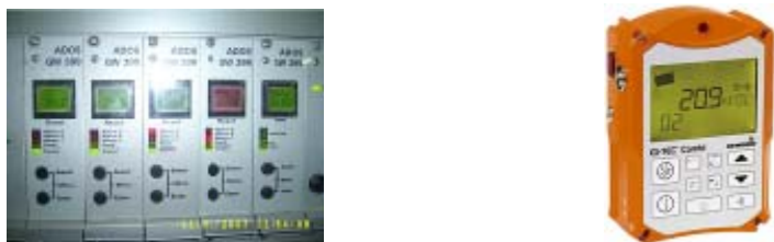
Abbildung 4.3.3 Gasmessgeräte; Links: stationäres Gerät; Rechts: mobiles Gerät für Einzelanalysen, auch einstellbar für Personenschutz; Fotos: DBFZ, Sewerin
