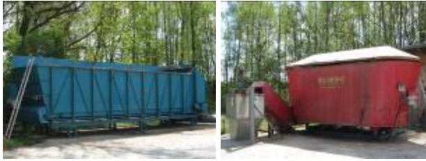
Abbildung 3.1.24 Feststoffeintragsysteme; Fotos: DBFZ
