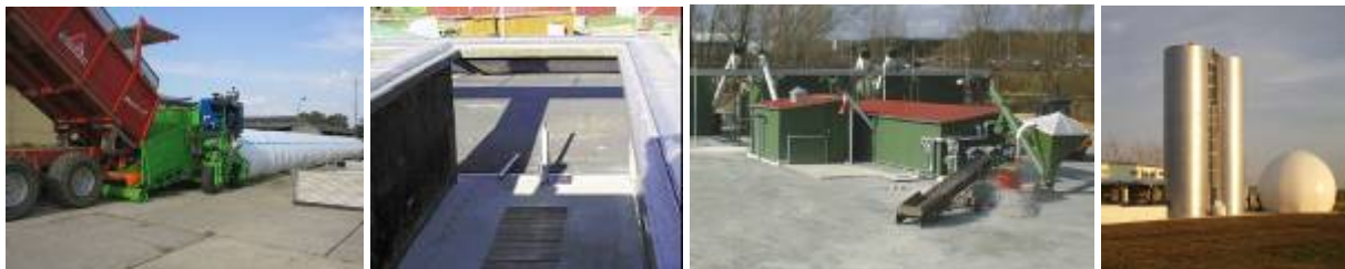
Abbildung 3.2.8 Beispiele für Sonderbauformen in der Feststoffvergärung; Folienschlauchvergärung (links), Aufstauverfahren (Mitte links), durchmischte Boxenfermenter (Mitte rechts), Methanstufe des Trocken-Nassvergärungsverfahrens und externer Gasspeicher
