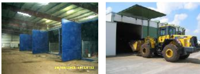
Abbildung 3.2.5 Beispiele für stationäre Boxenfermenter; Tür zur Seite (links), Tür nach oben (rechts); Fotos: DBFZ (links), Bekon GmbH (rechts)
