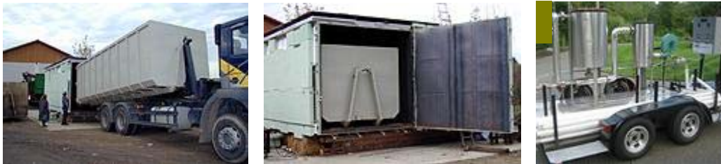
Abbildung 3.2.6 Beispiele für mobile Boxenfermenter; Einschubfermenter mit Abrollcontainer (links, Mitte), Komplettsystem (rechts); Fotos: Bioferm GmbH (links, Mitte), ESC Corp. (rechts)
