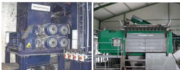
Abbildung 3.1.12 Vierwellenzerkleinerer (links), Zweiwellenzerkleinerer (rechts), Fotos: UNTHA shredding technology (links), Komptech (rechts)
