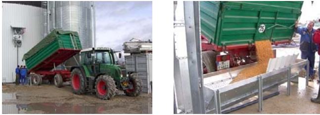
Abbildung 3.1.3 Entladen in Aufnahme­trichter zur Befüllung eines Hochsilos, Fotos: Weinzierl Lager- und Fördertechnik (beide)
