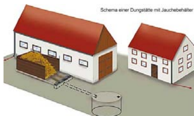
Abbildung 3.1.5 Schematische Darstellung eines Festmistlager; Abbildung: Wasserwirtschaftsamt Ansbach
