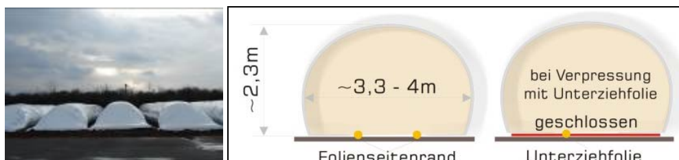
Abbildung 3.1.8 Folienschlauchsilos, Schema Tunnelquerschnitt bei der Verwendung von Folienbahnen; Fotos/ Abbildung: DBFZ, Alka Maschinen
