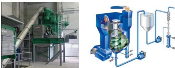
Abbildung 3.1.20 Stofflöser (links), Schema hydromechanische Aufbereitung mit Pulper und Sandabscheidung (rechts): Fotos: Komptech (links), BTA International (rechts)
