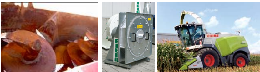
Abbildung 3.1.15 Mischschnecke mit Messerbesatz (links), Hammermühle (Mitte), Feldhäcksler (rechts); Fotos: DBFZ (links), Riela (Mitte), Claas (rechts)
