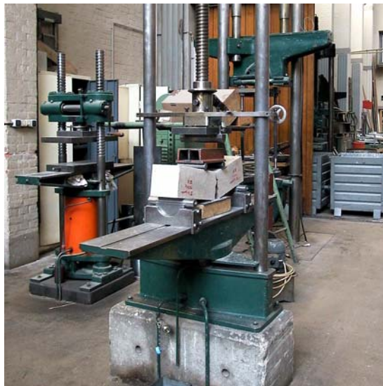
Abb. 7.48 Biegezugfestigkeits-Messung an einem Prüfprisma 100 x 100 x 700 mm
