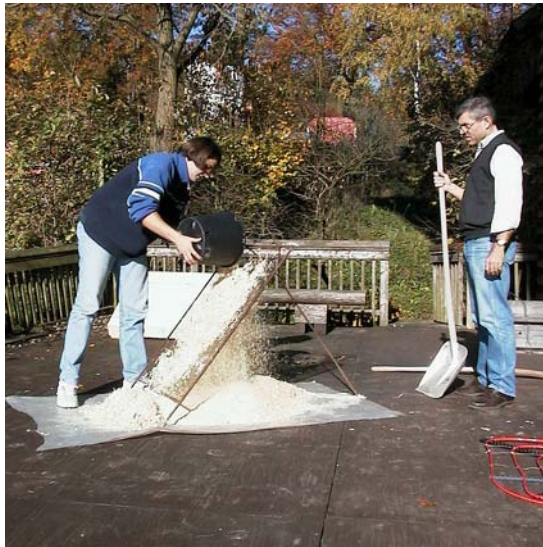
Abb. 6.13 Siebung des Restholzsortiments
