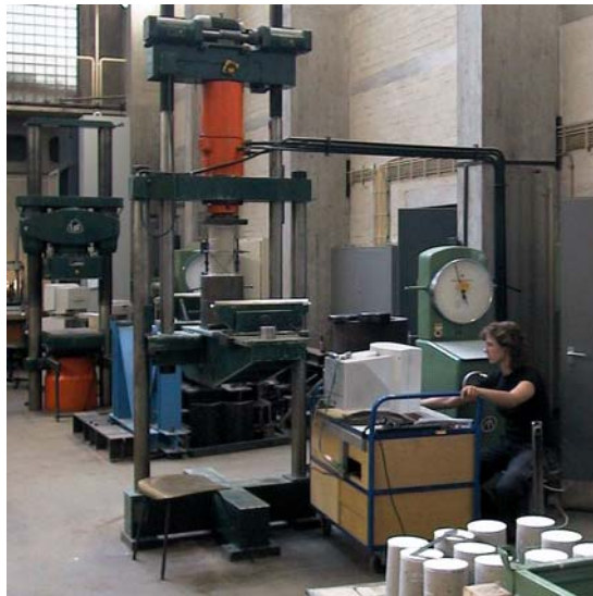
Abb. 7.46 E-Modul-Messung an einem Prüfzylinder der \varnothing 150 mm
