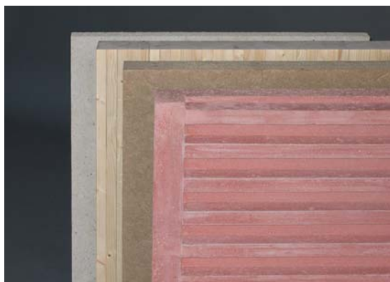
Abb. 8.33 'Außenwandbaukasten' (60 x 60 cm): Dreischichtiger Aufbau, BS + zusätzliche Dämmung + HLB "Welle" (außen)
