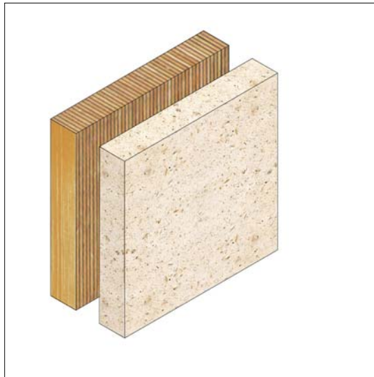
Abb. 8.27 Zweischichtiger Aufbau, BS + HLB (außen)
