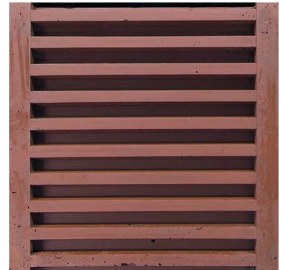
Abb. 10.4.3c Oberfläche der Mischung 3 'Rippe'/Reckli #1/34 (Verkleinerung, Platte 60 x 60 cm)
