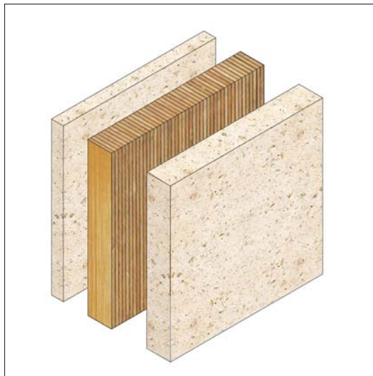
Abb. 8.28 Dreischichtiger Aufbau, HLB (innen) + BS + HLB (außen)
