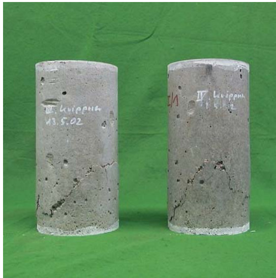
Abb. 7.42 Prüfcylinder (R III, links/ R VI/IV)1, rechts) mit unterschiedlichem Bruchbild nach Druckfestigkeitsversuch
