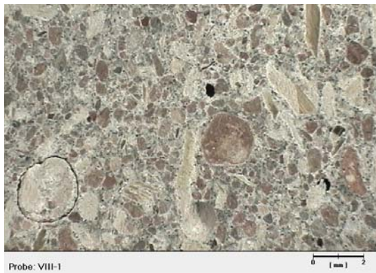
Abb. 7.74 Aufnahme unter dem Mikroskop der Rezeptur VI (Vergrößerung \approx 20:1)
