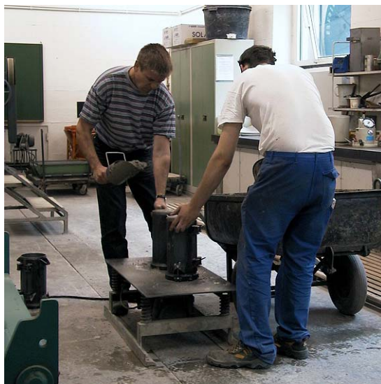
Abb. 7.41 Verdichtung von Prüfzylindern auf einem Flachrüttler
