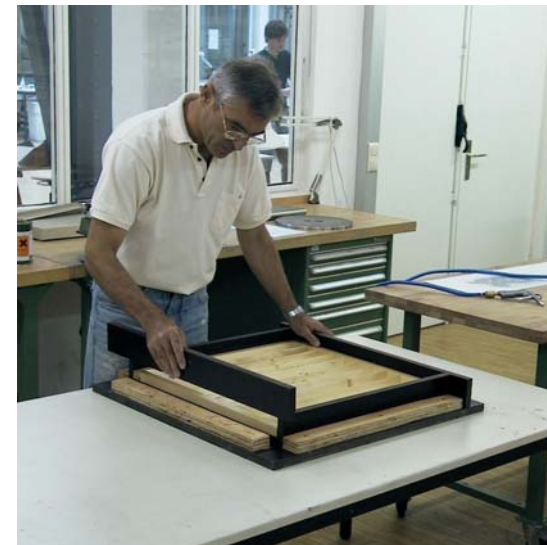
Abb. 7.11 Zusammenbau einer Schalung
