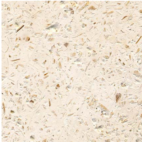
Abb. 8.24 Holzleichtbeton-Oberflächen mit Weißzement (EPFL/I-Bois, 2000)
