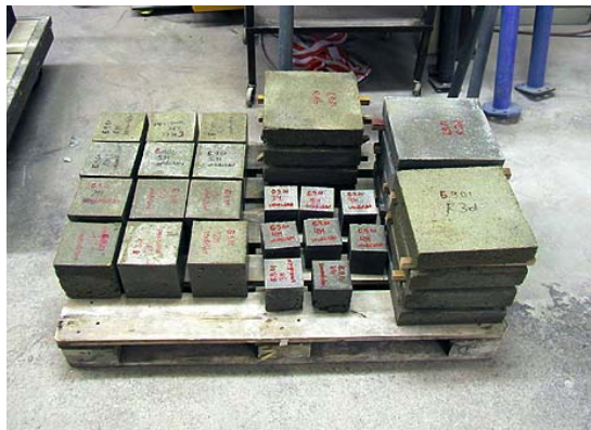
Abb. 7.22 Verdichtung der Prüfwürfel (15 cm) der Mischung R I a-b
