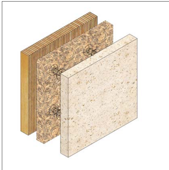
Abb. 8.29 Dreischichtiger Aufbau, BS + zusätzliche Dämmung + HLB (außen)
