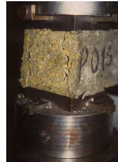
Abb. 5.5 Druckfestigkeitsversuch an einem Holzleichtbeton-Prüfkörper (EPF Lausanne/I-Bois)
