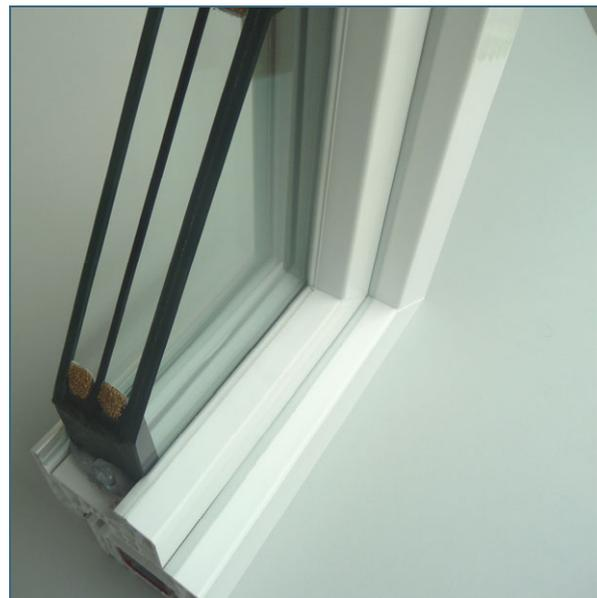
Abb. 6: 3-Scheiben-Verglasung mit sehr gutem Schall- und Wärmeschutz. Gut zu erkennen: der asymmetrische Scheibenaufbau
